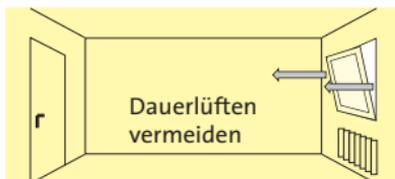
erhöht und damit die Belüftungszeit verringert werden, indem durch **Querlüften** Durchzug hergestellt wird. Je kälter die Außenluft, umso mehr Wasser kann sie beim Erwärmen aufnehmen. Im Winter wird also beim Lüften mehr Feuchtigkeit aus dem Raum entfernt als im Sommer.
